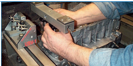
linke Verschiebeschiene auflegen
