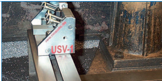
Aufspannböcke auf die Paralleleiste
