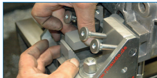
Zylinderkopf mit Spanneisen befestigen
