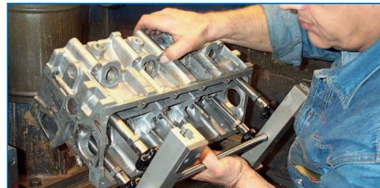
Zylinderkopf um 180° Überkopf drehen
