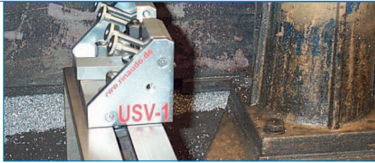
Aufspannböcke auf die Parallelleiste
