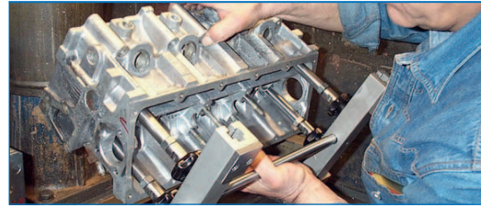
Zylinderkopf um 180° Überkopf drehen
